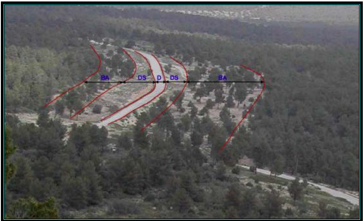
Imagen 38: Estructura de área cortafuegos apoyada en vial. (D: banda de decapado (la constituye el propio vial); DS: banda de desbroce; BA: banda auxiliar).
